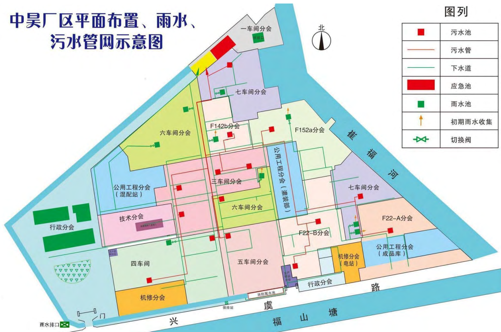
图 7.7.2-2 全厂雨水、污水管网示意图
