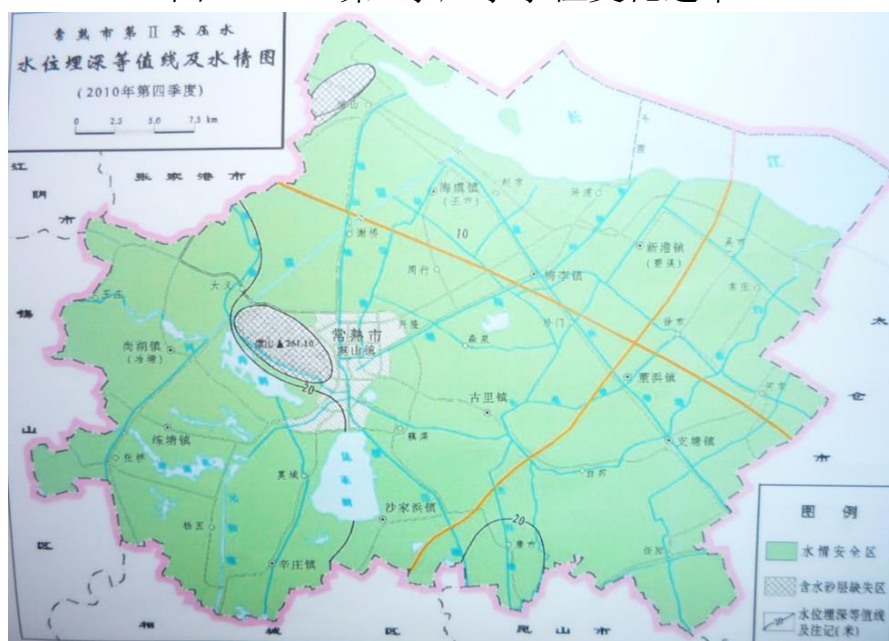
图 5.1.6-4 第II承压水水位埋深图
