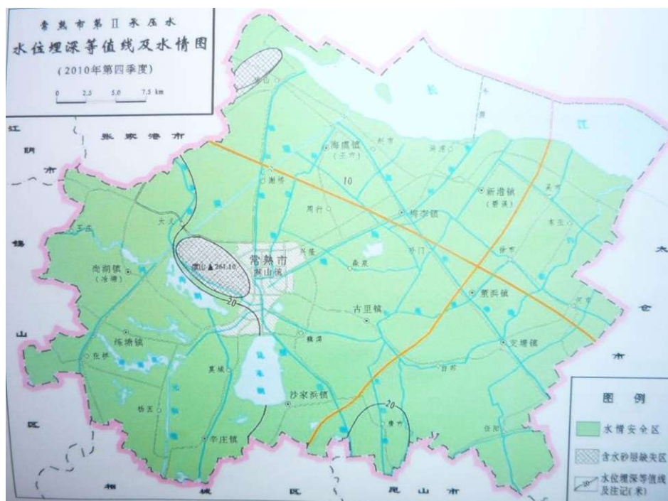
图 6.5.1-4 第 II 承压水水位埋深图
