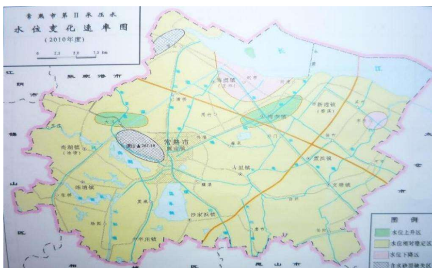
图 5.1.6-3 第 II 承压水水位变化速率
