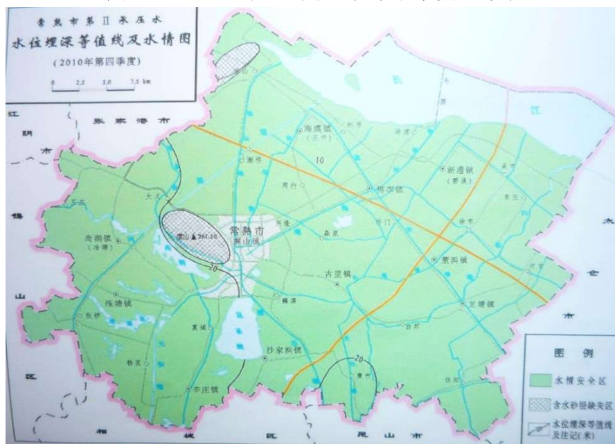
图 5.1.6-4 第 II 承压水水位埋深图
