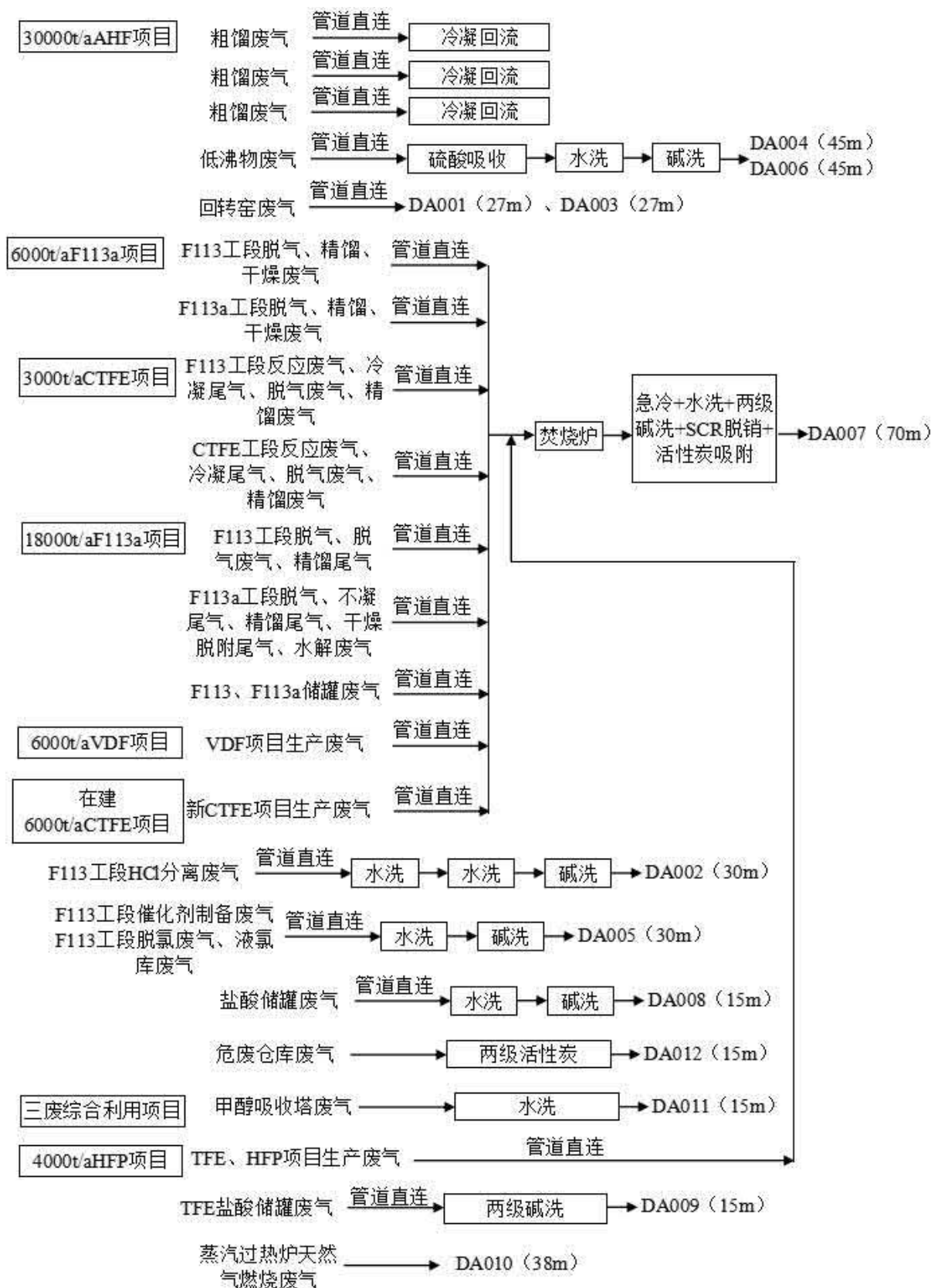
图 3.1.5-2 现有项目废气收集、处理、排放示意图
