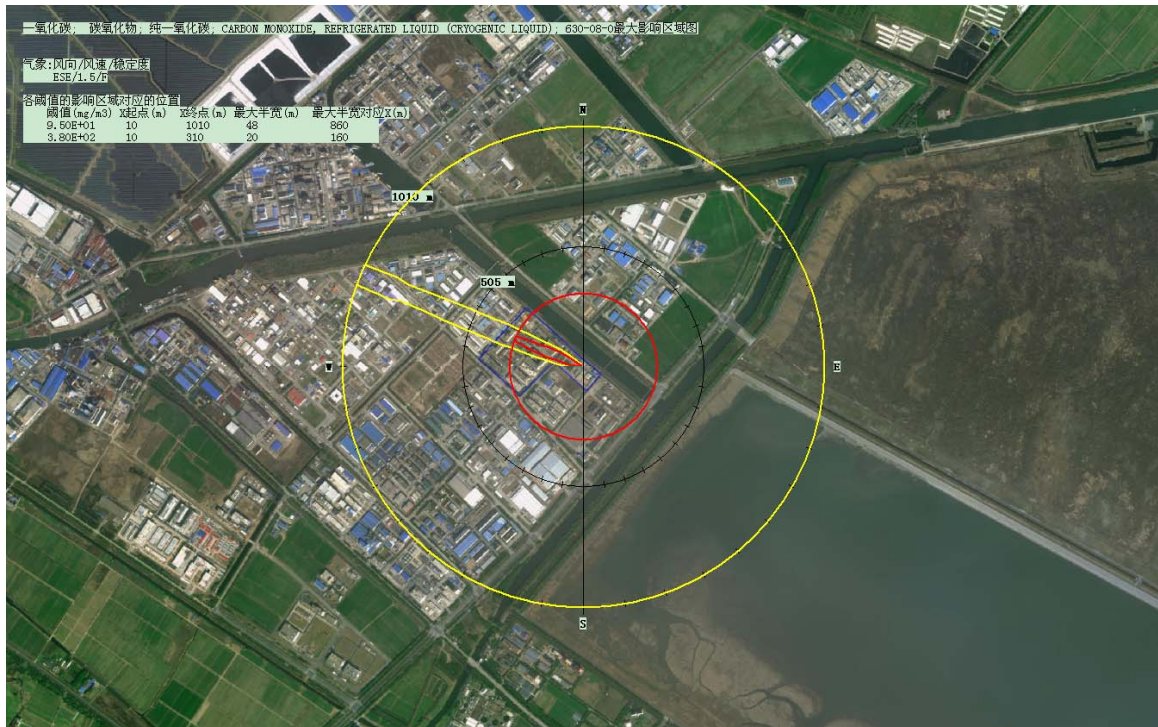
图 6.7.3-3 最不利气象条件下乙烯不完全燃烧产生 CO 最大影响区域图
