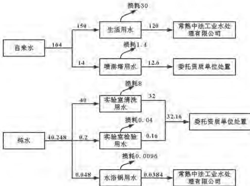
图 2-2 本项目改建后水平衡图 (t/a)
