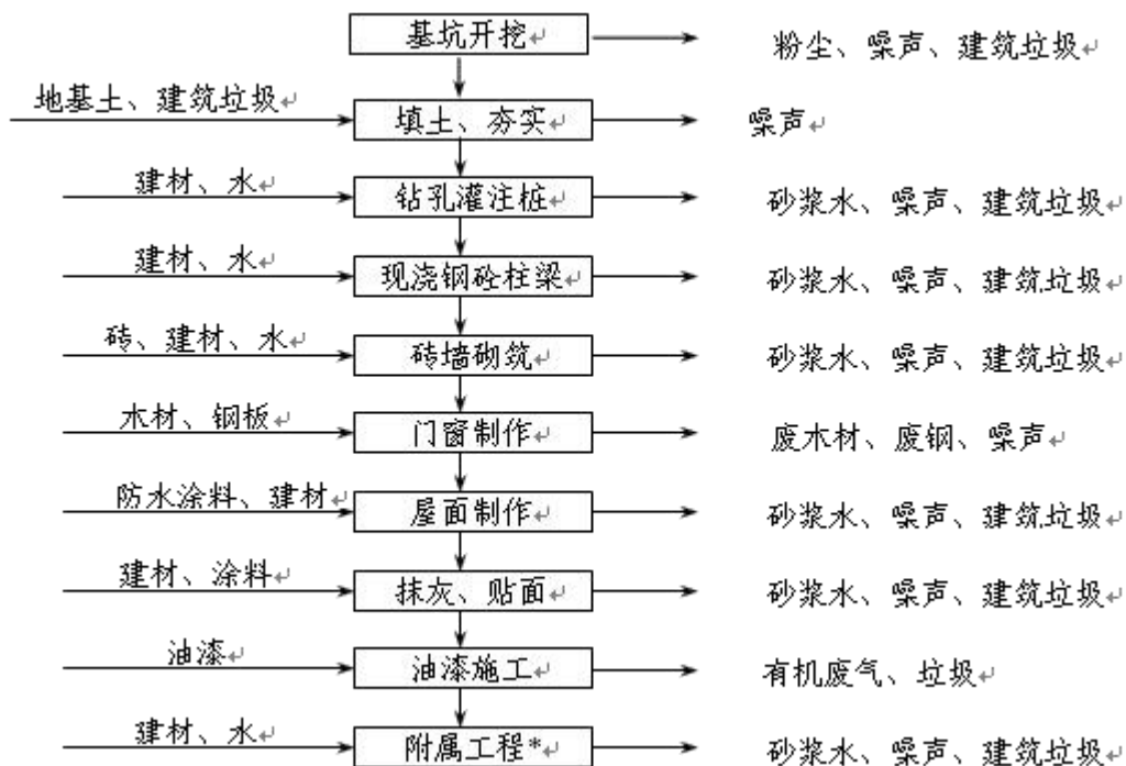
图 4-1 施工期建筑工艺流程图
