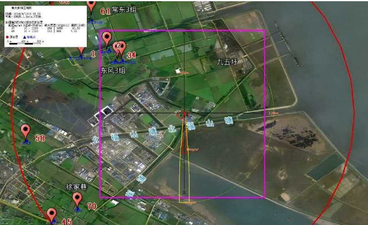
图 5.7-13 最不利气象条件下超过阈值的最大轮廓线影响区域图（甲醛）
