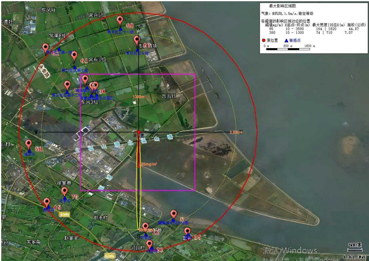
图 5.7-31 最不利气象条件下超过阈值的最大轮廓线影响区域图 (CO)
