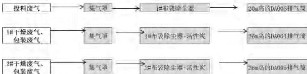
图 6.1.1-1 技改项目废气收集和走向情况图
