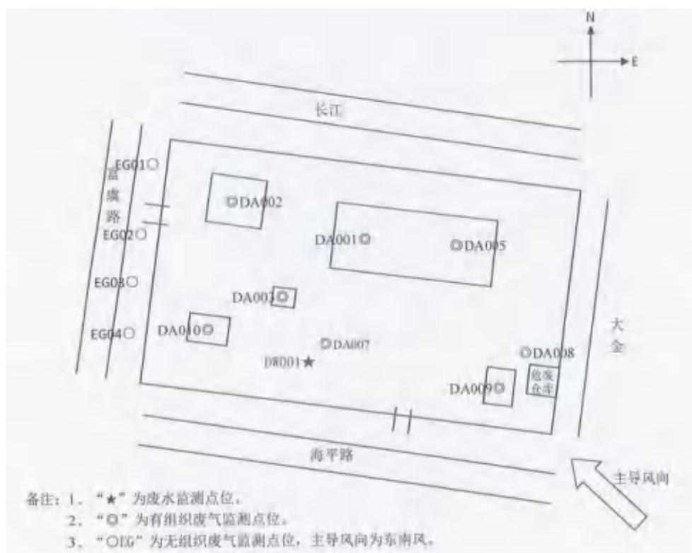
图 3.1.4.2-4 厂界无组织废气监测点位图
