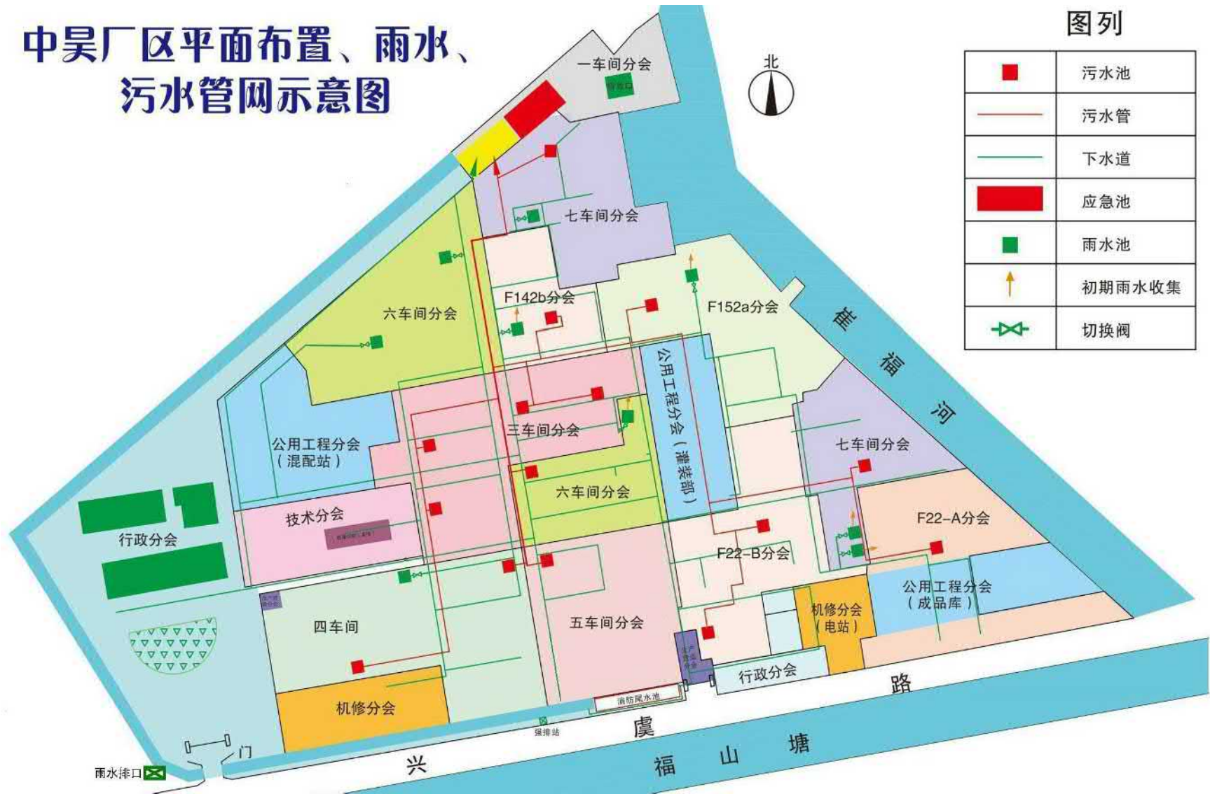
图 5.1-3 全厂雨水、污水管网示意图
